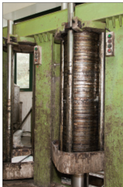
將烘焙、塑形好的芝麻放入壓榨機上，就可製出香氣濃郁、口感滑潤的芝麻油。
