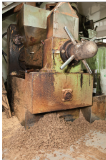
不同的油適合不同的壓榨法，苦茶油適合使用螺旋壓榨法，油質清澈。
