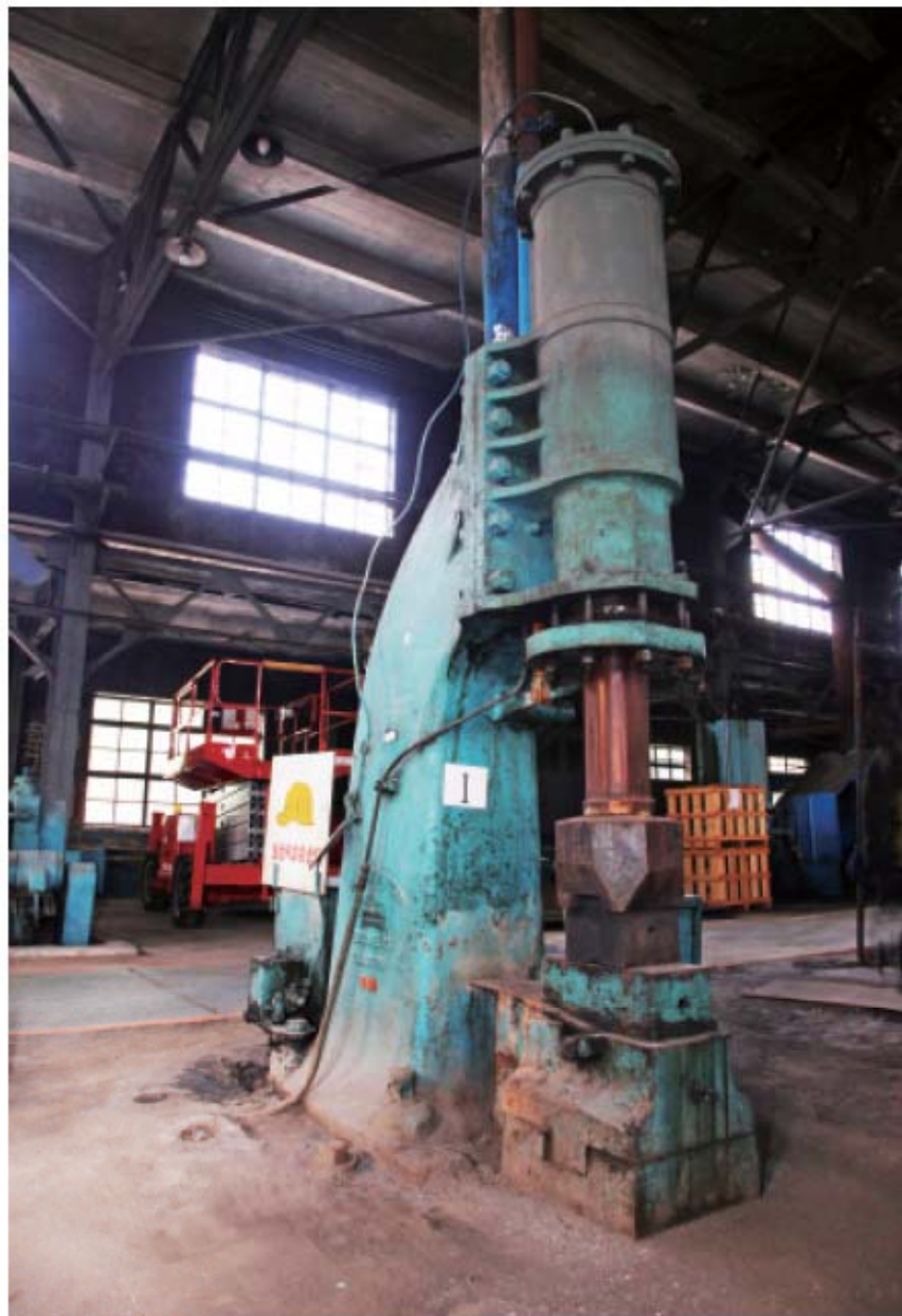
負責鍛造設備零件的鍛冶工場內，一座1889年、劉銘傳時代製造的蒸汽錘，相當具有歷史價值。
