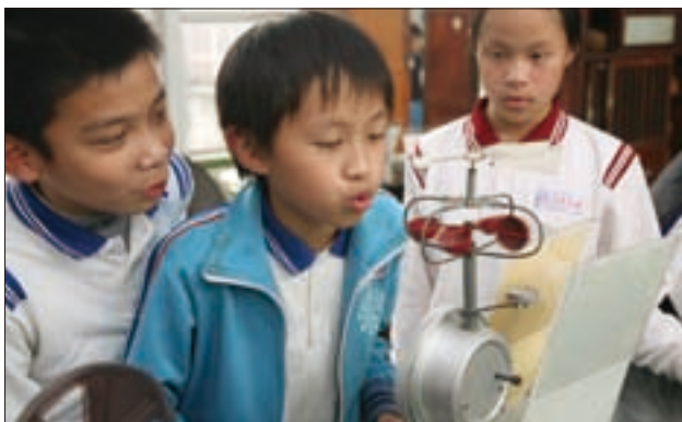
小型風速計上有測量風向的風標、杯狀扇葉和儀表面板。
