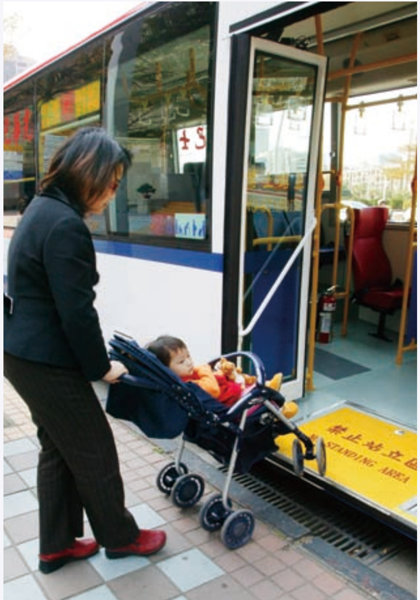
低底盤公車車廂離地僅35公分，嬰兒車可以直接推入公車，不必折疊。
