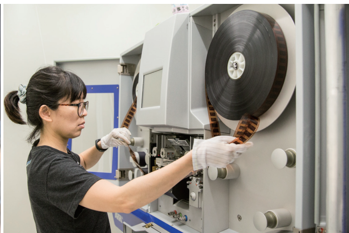
左：使用接點膠水處理膠卷髒點時，必須注意塗抹厚度，避免表面高度不均導致數位掃描出現晃動。右：數位掃描的過程中，可能因為膠卷的狀態不一而有掃描缺失的狀況發生，必須憑藉操作經驗調整機台。
