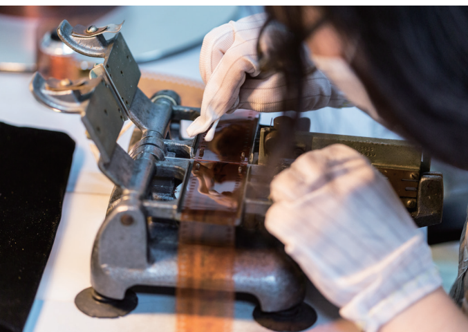
左：使用接點膠水處理膠卷髒點時，必須注意塗抹厚度，避免表面高度不均導致數位掃描出現晃動。右：數位掃描的過程中，可能因為膠卷的狀態不一而有掃描缺失的狀況發生，必須憑藉操作經驗調整機台。
