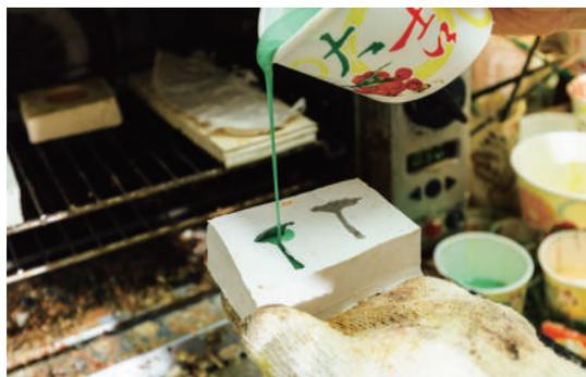
上：將矽膠注入盛有食品樣品的紙盒，靜置一晚才會成形外殼模型。下：將基底為淺綠色的熱塑樹脂倒入外殼模型，並送入烤箱烘烤，便能完成食品模型的雛形。
